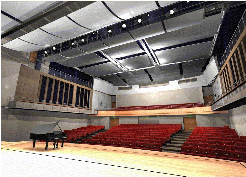
Rys. 2.102. Sala koncertowa Akademii Muzycznej w Katowicach (rzut i widok, koncepcja 2003). Kubatura 4000 m 3 , widownia 318 miejsc. Za ścianami bocznymi znajdują się komory pogłosowe o otwieranych wlotach. Architektura: Stanisław Lessaer
