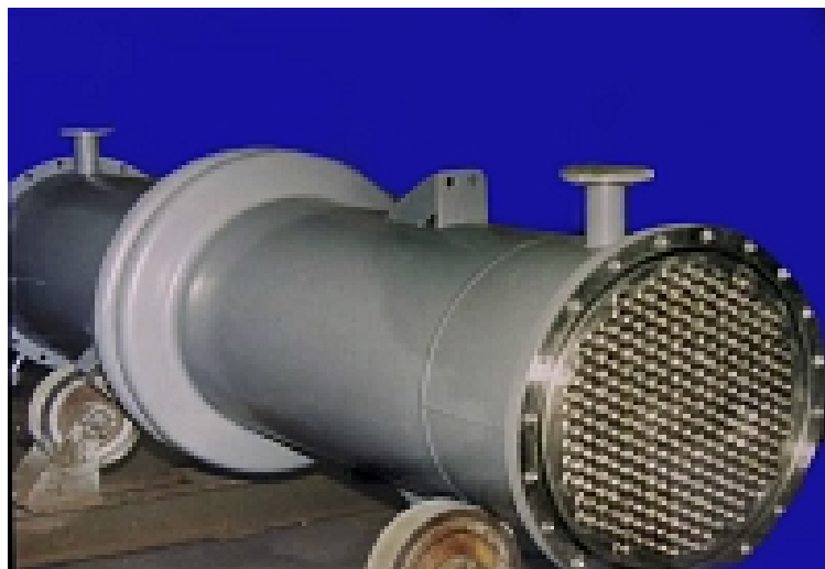
Płaszczowo-rurowy wymiennik ciepła – widok płaszcza i płyt sitowych.
