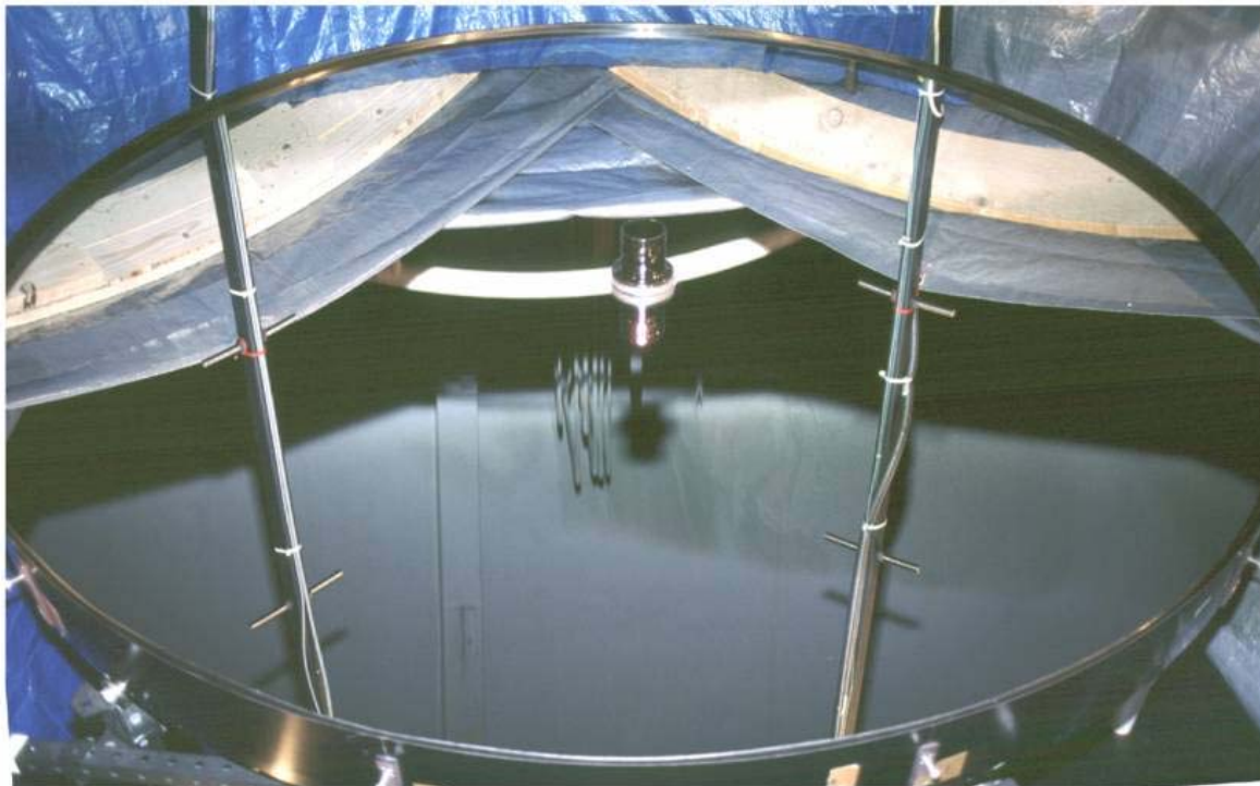
3.0 m NASA Liquid Mirror. Prękość obrotowa 1.043 radian/sek. ; 14 litrów Hg , warstwa 1,6 mm
