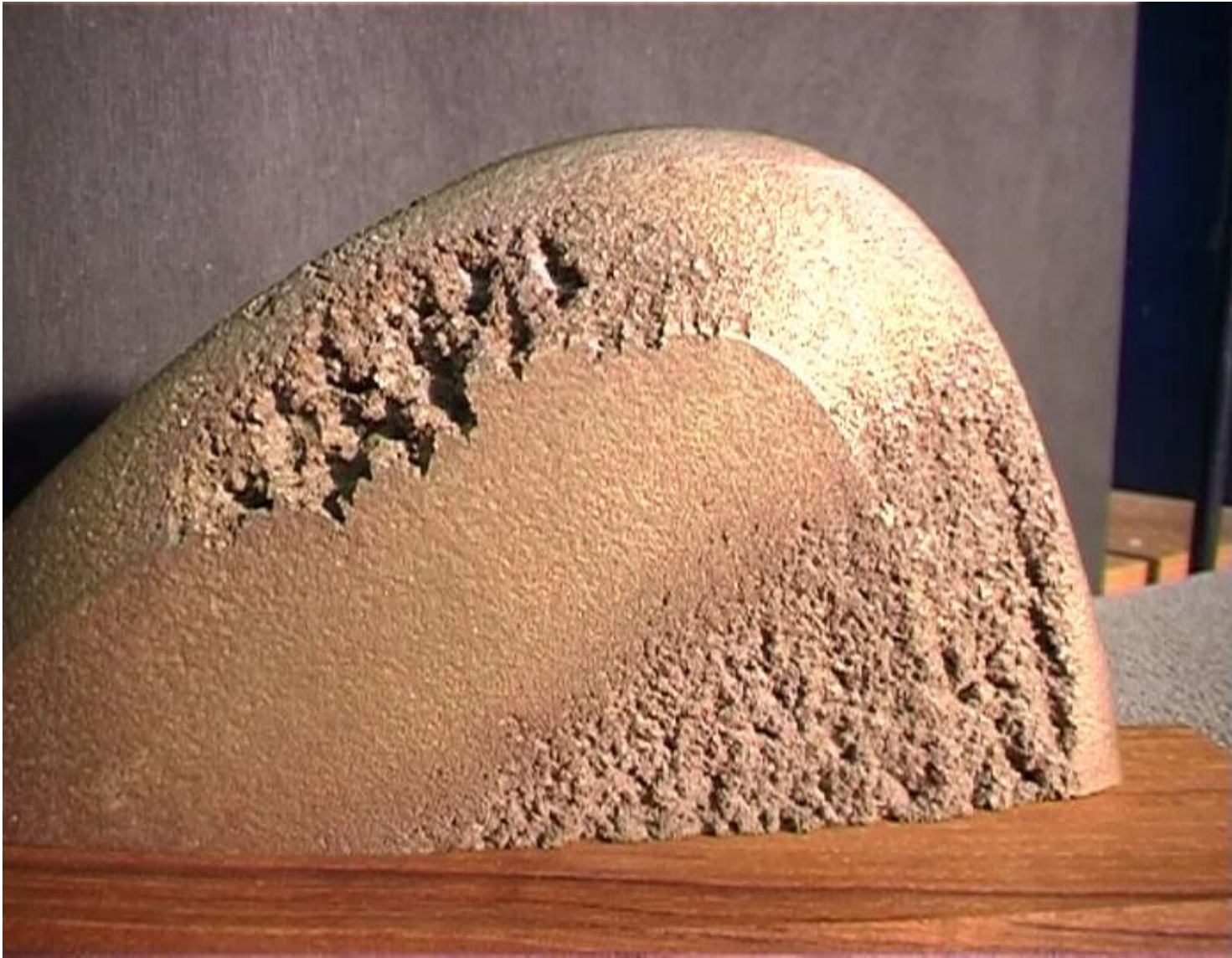
Konsekwencje kawitacji – Consequences of cavitation
