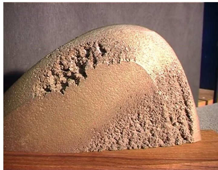
Fragment zniszczonego przez erozję skrzydła śruby
