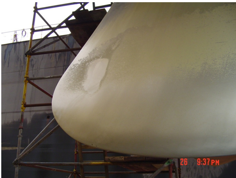
Wstępna faza erozji skrzydła śruby napędowej
