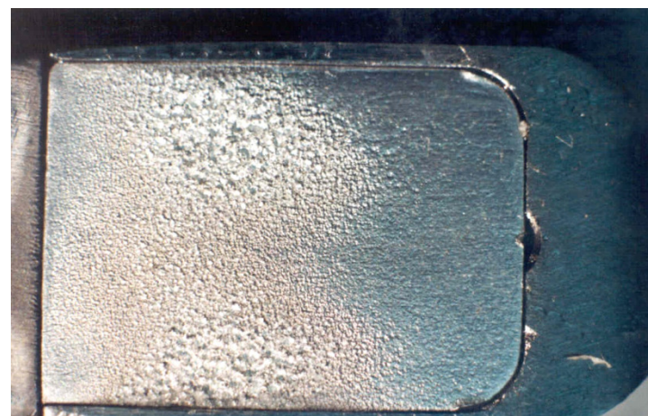
Próbka aluminium po teście erozyjnym
