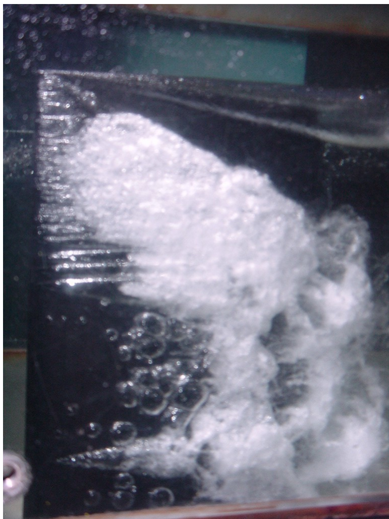
Porównanie obserwowanego i obliczonego zakresu kawitacji
