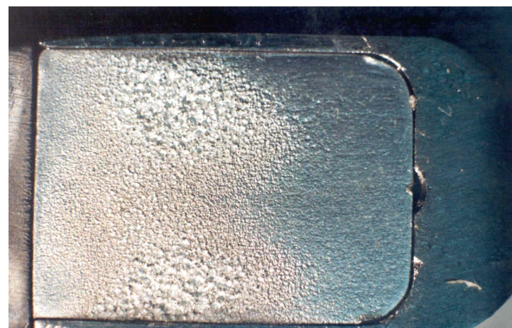
Próbka aluminium po teście erozyjnym
