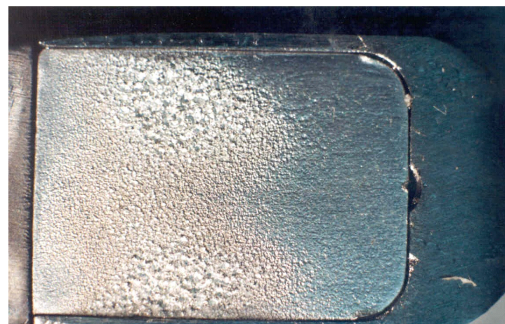
Próbka aluminium po teście erozyjnym
