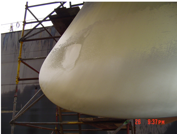
Wstępna faza erozji skrzydła śruby napędowej
